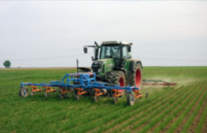
6-m-Hacke im Frontanbau mit 6-m-Striegel im Heck
