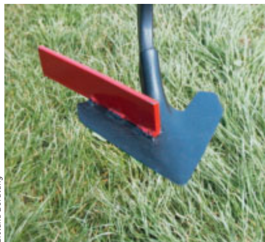
Aufgeschweißtes Flacheisen auf einem Gänsefußschar
