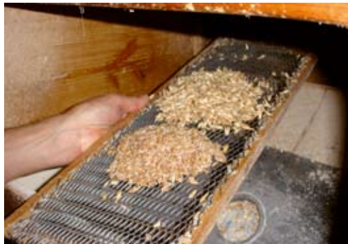
Von einer optimalen Entspelzungsanlage wird eine restlose Trennung des Spelzes vom Kern erwartet, ohne die Keimfähigkeit des Korns zu beeinträchtigen, den Kern zu beschädigen oder gar zu brechen.
