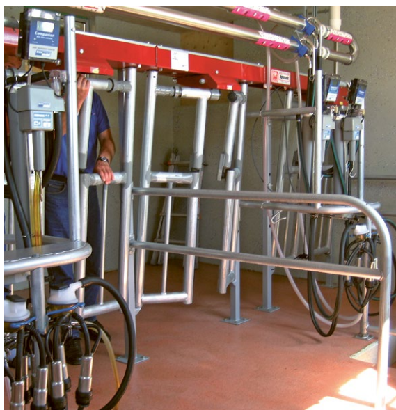
Im Butterfly-Melkstand sind für die Hörner eventuell Anpassungen an der Konstruktion nötig.
