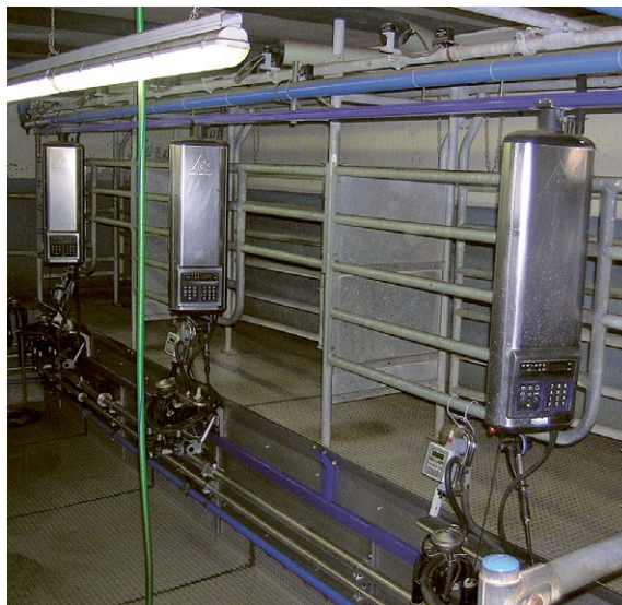
Der Tandem-Melkstand bietet einen guten Überblick und ermöglicht einen engen Kontakt zum Einzeltier.
