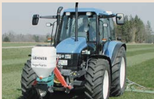
Für die einfache Übersaat eignet sich ein Universalstreuer, hier in Kombination mit einer Wiesenegge.
