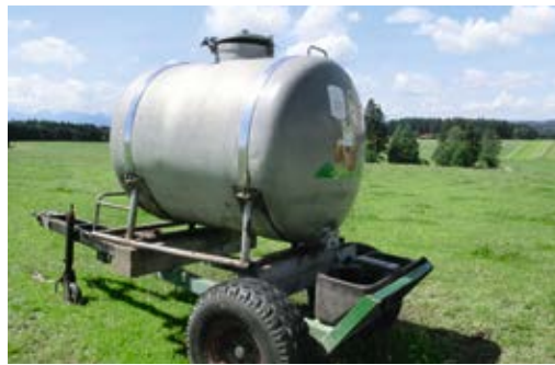
Mobile Tränken können mit den Kühen zusammen von einer Weidefläche zur nächsten bewegt werden und erfordern keinen Wasseranschluss.
